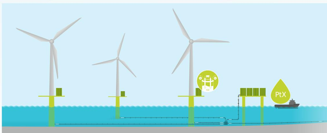
Aufbau der H<sub>2</sub>Mare-Anlage mit Elektrolyseur-Containern am Turmfuß. Der gewonnene Wasserstoff wird durch eine Pipeline abgeführt oder für die Herstellung von Folgeprodukten genutzt, die sich leichter transportieren lassen.
